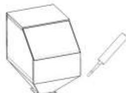
**Места соединения бункера желательно уплотнять герметиком или уплотнительной лентой.**
